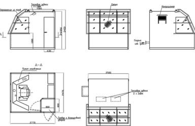
Кабина оператора буровых установок устанавливается на бурильной платформе и служит для обеспечения комфортной и безопасной работы оператора.
