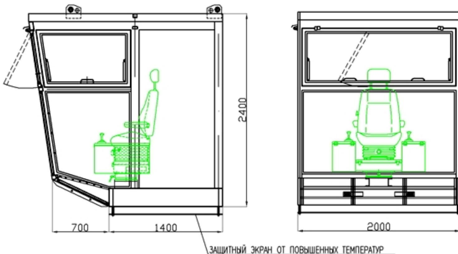
Кабина изготовлена с повышенной защищенностью от загазованности и запыленности а также от токопроводящей пыли;
